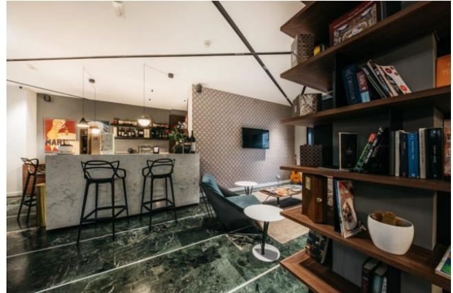
Di grande effetto la soluzione adottata per l'**illuminazione a soffitto**: un intersecarsi di linee nere di larghezza ridotta, create da esperti artigiani, al cui interno sono alloggiati i **faretti LaserBlade di iGuzzini**. I banconi del ricevimento e del bar sono invece illuminati dalle **lampade a sospensione String Light di Flos**.
